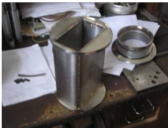
Рис. 10. Новая пикап станция в процессе сборки в опытном производстве ЛФВЭ.
