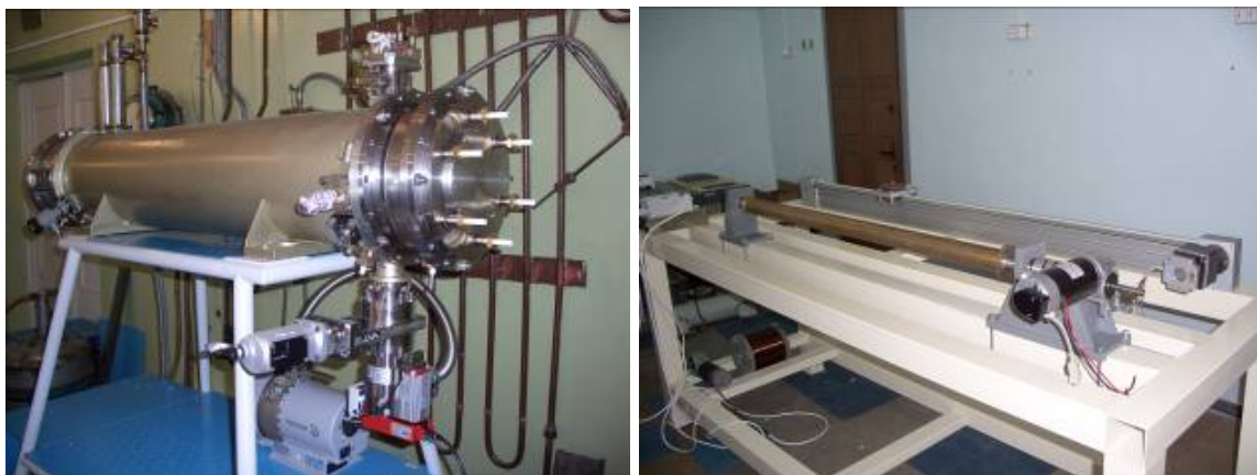
Рис. 1. а) криогенная камера и вакуумная система нового источника Крион-6Т в сборе; б) автоматическое намоточное устройство для изготовления сверхпроводящего соленоида.
